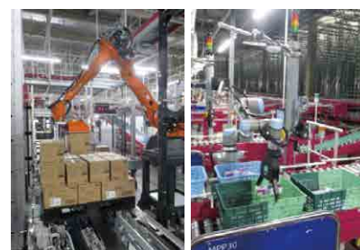
写真5.6 PALTACのケースピッキング(パレタイズ)ロボットとピースピッキングロボット (月刊マテリアルフロー2019年11月号より引用)
