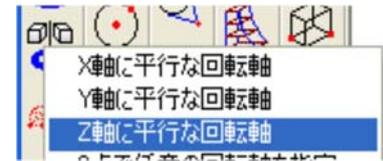
画面左下のメッセージが「(点)回転の中心[CTRL]で複数回コピーする」と表示されるので、回転軸となる中心(右図印)を[Ctrl]キーを押しながら右クリックします。
