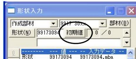
『部材形状表示』ウィンドウに加工した部材が表示されたことを確認して部材を配置します。(加工に使用した部材は削除してから配置してください。)
