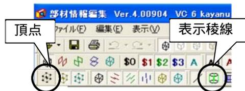
視点を正面図にして、下図の不要な稜線をクリックして選択し、画面下の【表示なし稜線】を押して設定します。
