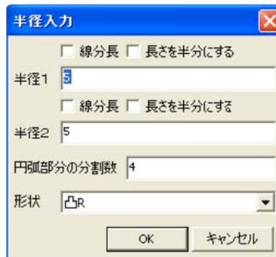
【OK】を押すと、画面左下に「(図形) 始めの直線」とメッセージが表示されますので、半径1で設定した数値で丸めたい線をクリックします。(下図)
