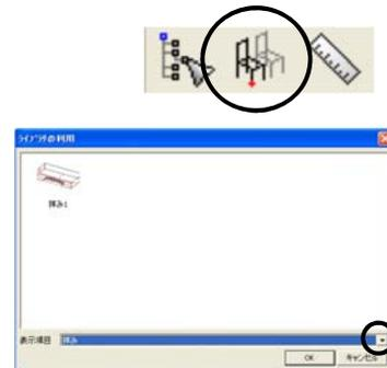
画面左下に、「置く場所を指定 [ENTER] で配置時のパラメータを指定 [SPACE] で表示切替」とメッセージが表示され、マウスに部品の輪郭がついてきます。部品を配置する基準となる点「8327」部材の左端を右クリックします。
