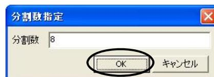
下図のように分割数「8」で擬似曲面が生成されます。続けて**Delete**キーを押して、3本の曲線を削除します。
