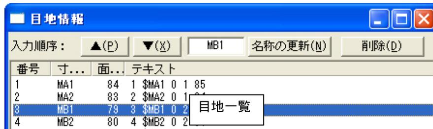
入力順序【 ▲(P) 】...選択した目地寸法パラメータの入力順序を上に入れ替えます。MICS/Proの墓石設計で実際に部材を使用する際に目地寸法パラメータの入力順序が正しくないと単純な部材でも作業がしにくくなります。
