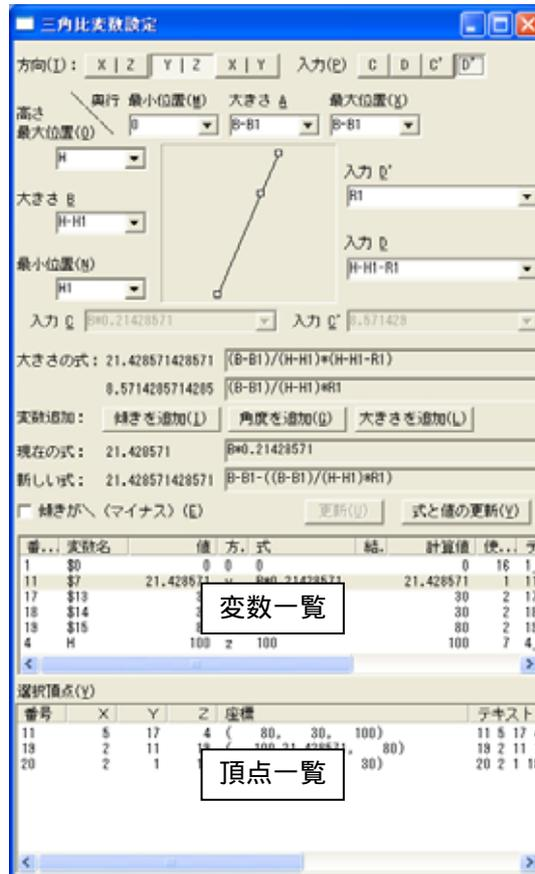
方向...選択した頂点がどこの面に対して計算するかを設定します。計算対象の頂点を選択した時点で自動的に計算対象面は決まりますが、選択した頂点の傾斜の属する面が XY, YZ, XZ の何れかと平行と自動的に判断できない場合や、平行以外の場合は、どの面か(「方向」)を指定する必要があります。
