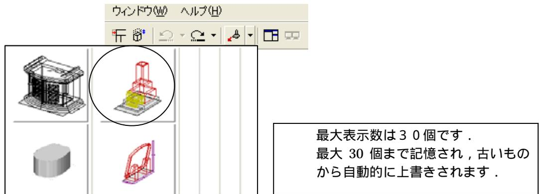
3. 選択したデータが赤の点線で表示されますので、挿入データの配置基準点をクリックして、[右クリック] - [複写先指定]を選択します。
