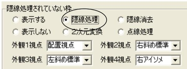
この設定は隠線処理されていない枠に対してのみ、有効です。隠線処理した枠に対してこの設定は反映されません。隠線処理後に表示を変更したい場合は枠を選択し、画面上の「隠線処理」メニュー内から表示方法を選択しなおします。
