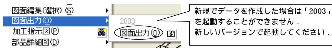
図面出力 2003・部品詳細図 2003 バージョン以前で作成したデータにつきましては、「図面管理」の右上にあります【図面出力】・【加・詳..】のボタンを選択することで、2003バージョンで起動することが可能です。
