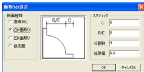
4. 画面左下に「面取りする辺（左ドラッグで範囲選択） [ CTRL ] クリックで端点の個別指定 [ ENTER ] で先へ進む」とメッセージが表示されるので、面取りする辺を選択します。
