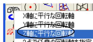
3. 原点を回転軸として何度回転させてコピーするかメニューが表示されますので「90」を選択します。再度メニューが表示されたら【コマンド終了】を選択します。
