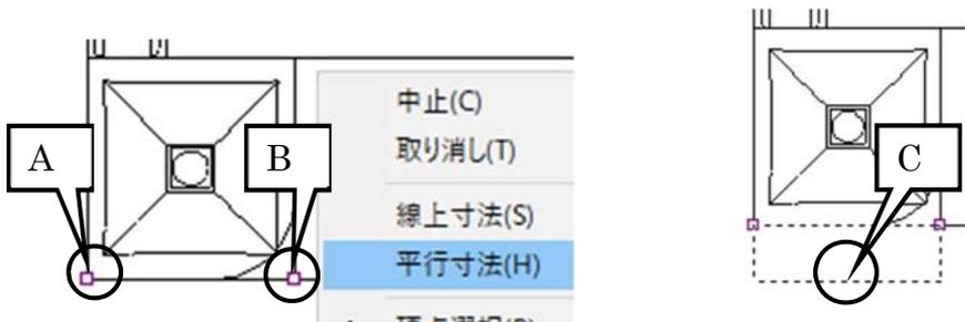
3. そのまま次の点 (階段右側) をクリックすると階段の寸法が表示されます。右側の親柱の角まで順番にクリックし [右クリック] - [実行] をクリックして確定します。
